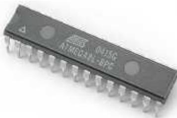
**Gambar 1.** Mikrokontroller ATmega 8
